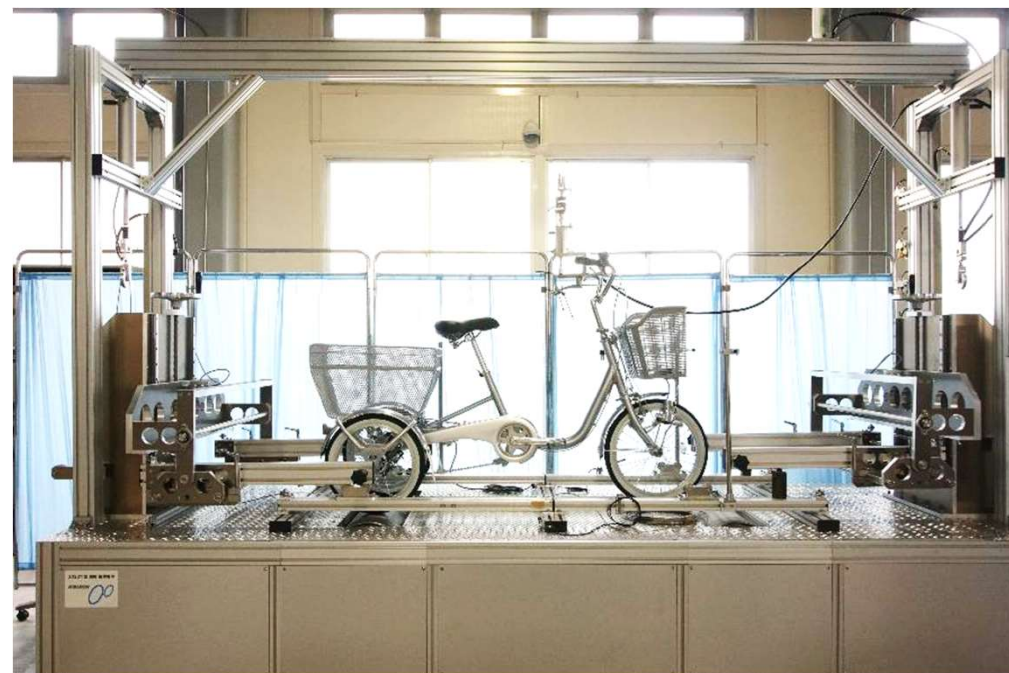
□三輪自転車の制動性能測定時の様子
