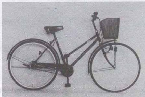
シティサイクル：主に日常の交通手段及びレジャーに用いる短中距離（CITY CYCLES）短中距離、低中速走行用自転車で車径の呼び25以上は軽快車を含む。
