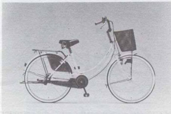
軽快車：主に日常の交通手段（通勤、通学、買物）に用いる（LIGHT CYCLES）短中距離、低中速走行用自転車で車径の呼び25以上、標準仕様による重量が14～20kgのものをいう。チェンジギヤ装置をもつものを含む。
