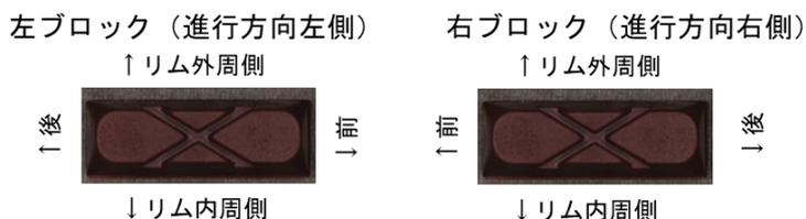
図 6 ブロック画像と取り付け時の方向との対応関係
