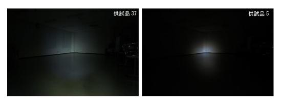
写真 8 全光東 100 lm、照射角 20°(左)と 90 lm、10°(右)
