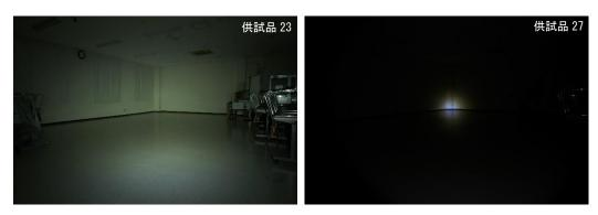
写真 7 最大光度 2, 230 cd、照射角 30°(左)と 2,573 cd、5°(右)
