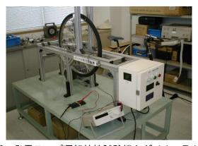
写真2 発電ランプ運転特性試験機とダイナモ取り付け
