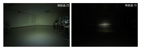
写真 6 最大光度 2,230 cd (左) と 2,880 cd (右) の水平面への照射
