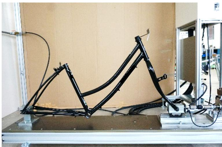
写真5 フレームの水平疲労試験機の外観
