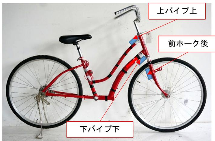
写真2 ひずみゲージ貼り付け位置
