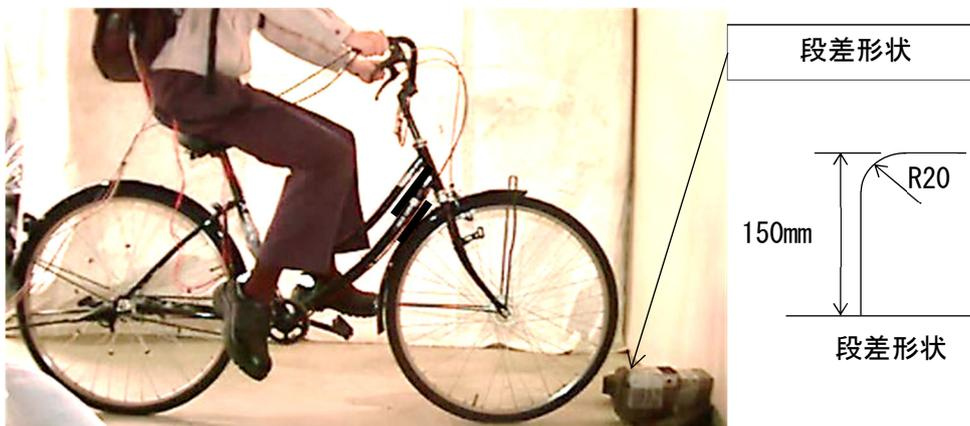
写真3 実走行での段差衝突
