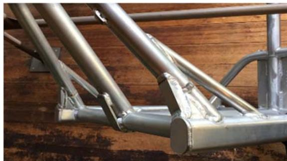
破断した箇所を補修し、追加のガセットを溶接
