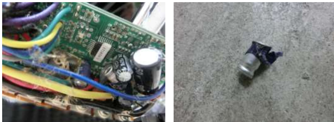
写真3 破裂したコンデンサ(供試車②)
