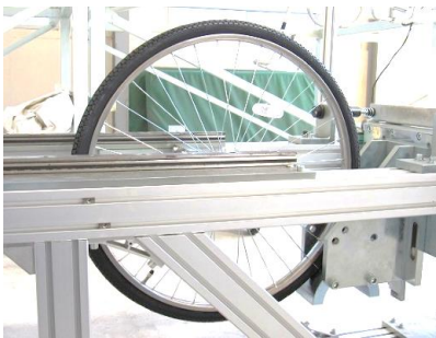
写真4. 1 edge test 車輪とトロリーの接触状態
