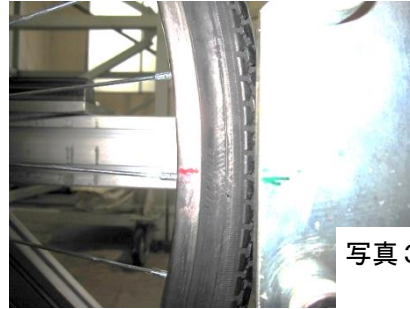
写真3. 1 impact test 車輪とトロリーの接触状態
