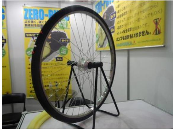
ノーパンクタイヤ、他社同種製品と比較して中空構造のため軽量。
