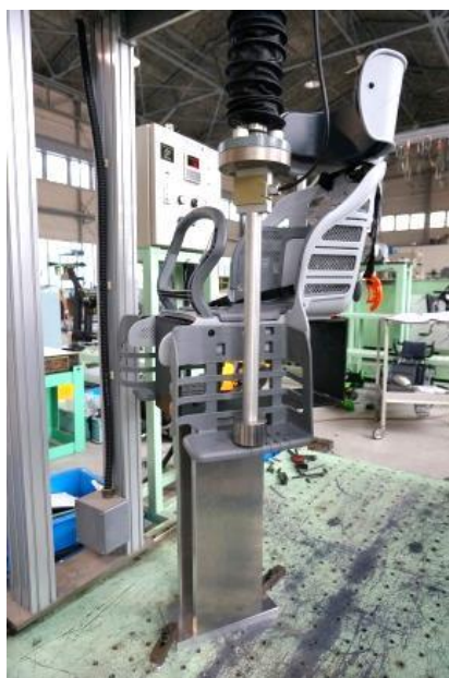
写真6 荷重負荷装置による足載せへの負荷状況。
