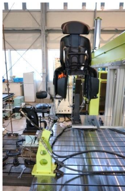
写真3 足乗せ斜め作動耐久試験
