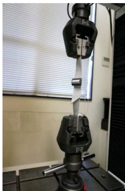
写真7 荷重試験機によるシートベルトの負荷状況。
