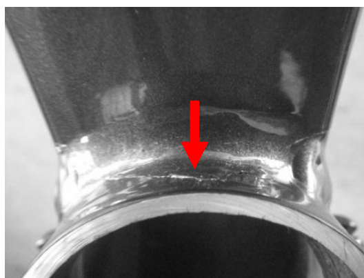
写真 6 疲労試験による疲労の様子
