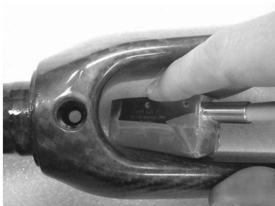
写真 1 開発した狭隙部用フラットプローブ（上：外観、下：使用時の様子）
