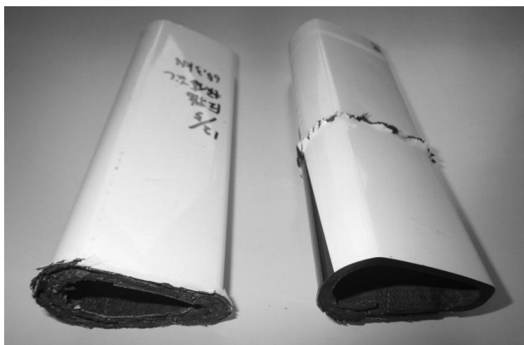
写真 5 圧縮強度試験後の破壊の様子（左：層間剥離なし、右：40J 落下衝撃付与）
