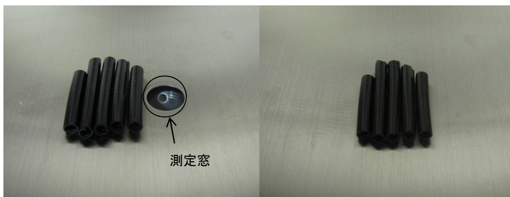
写真7 アウタワイヤの分析状況（右：測定窓上にセットした状態）
