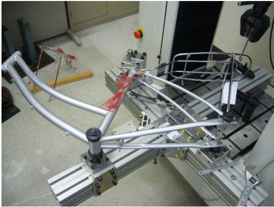
写真22 組み合せた方法：ハンガ、後ハブ軸、シートポスト固定する方法
