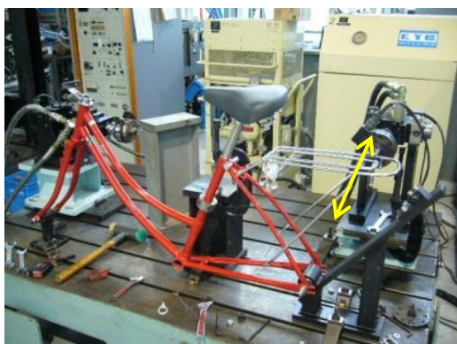
写真11 横方向動的強度試験状況
