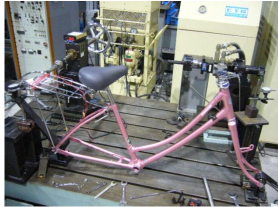
写真23 組み合せた方法：前後ハブ軸で固定する方法
