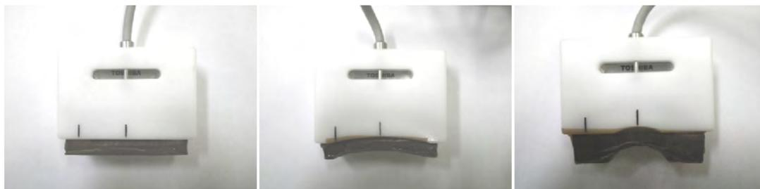
写真8 プローブ形状(左:フラット、中:コンケーブプローブ(内半径大)、右:コンケーブプローブ(内半径小))
