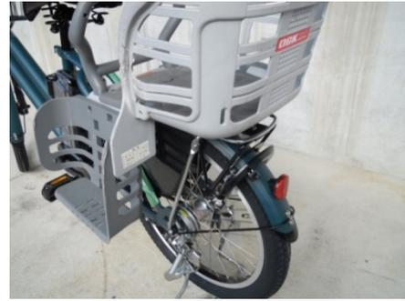
シリンダーをサークル錠側面に位置することで操作性を向上させるとともに、キーを差し込まないと施錠できない機構とすることで走行中にカンヌキが誤動作しないセーフティ機能を開発した。
