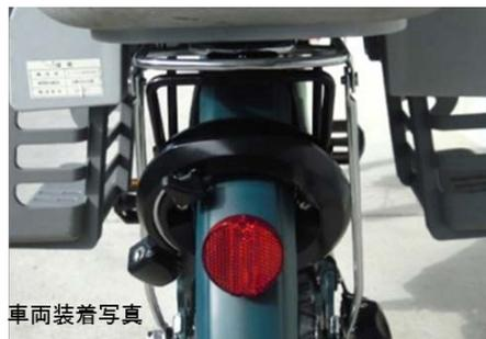
また、後付け用アタッチメントの設計については、市場調査を進めるなかで、駐輪スペースが限られ、より駐輪環境が厳しくなる学校施設などでの需要見込みを受け、クラス 18～27 の線材キャリヤに取付けられることを優先した設計とした。本製品は子乗せ車を中心とした小径モデルでの需要が高いことを前提としていたが、市場調査を行う中で、子供同乗を目的とした車両の多くがパイプキャリヤを採用しており、デザイン性の面から多種多様なキャリヤが存在、汎用性の確保が難しいことがわかった。
