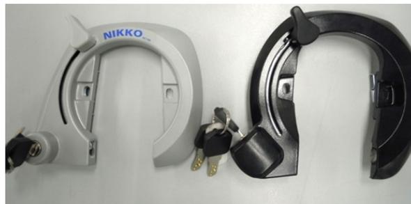
従来のサークル錠では当たりまえとなっている「開錠状態でキーが本体に残る構造」が、キャリヤ後端ではキーホルダー等のアクセサリ装着時に車輪への巻き込みを誘発する恐れがあることから、施錠、
