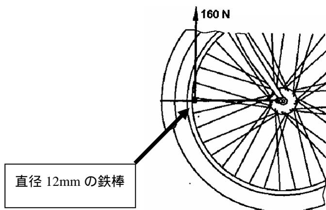
図1 どろよけ接線方向の妨害試験
