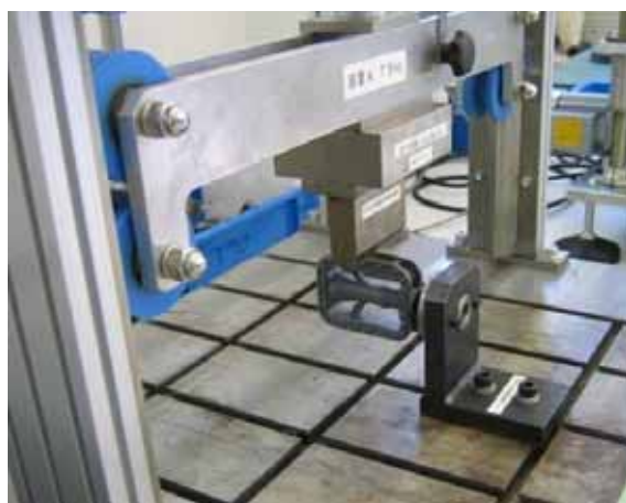
写真C-3 ペダルの耐衝撃試験状況
