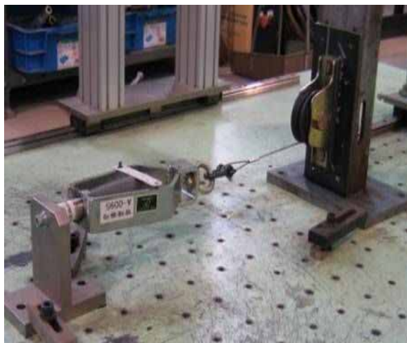
写真C-1 にぎりの離脱力試験状況
