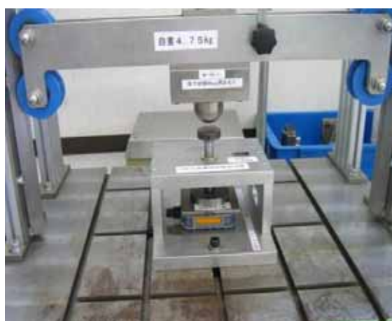
写真C-2 ペダルの耐寒試験状況
