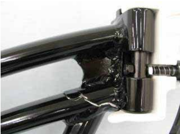
No.19繰返し荷重試験による接合部亀裂
