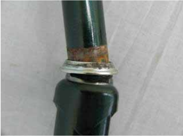
No.16繰返し荷重試験による前ホーク破損
