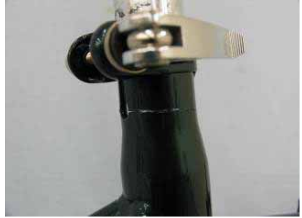
No.16耐振性試験による立パイプ亀裂
