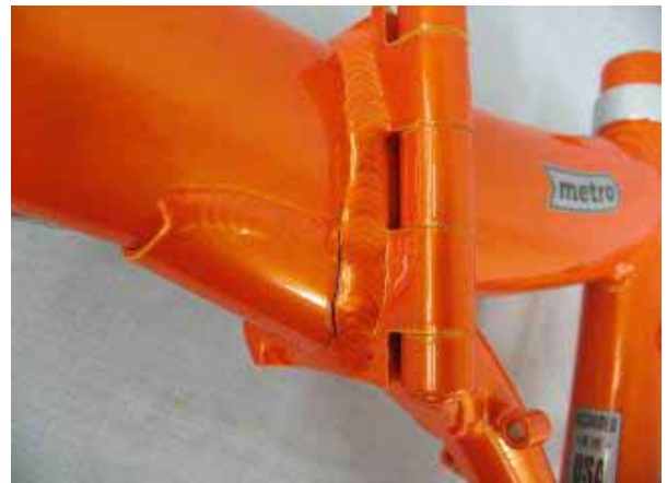
No.29前倒し衝撃試験による接合部亀裂
