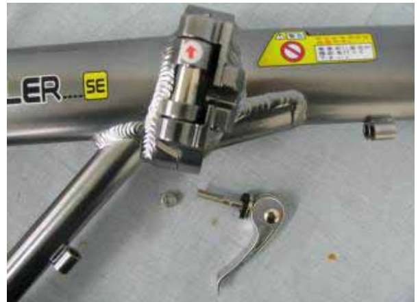
No.27耐振性試験による連結ピン破損
