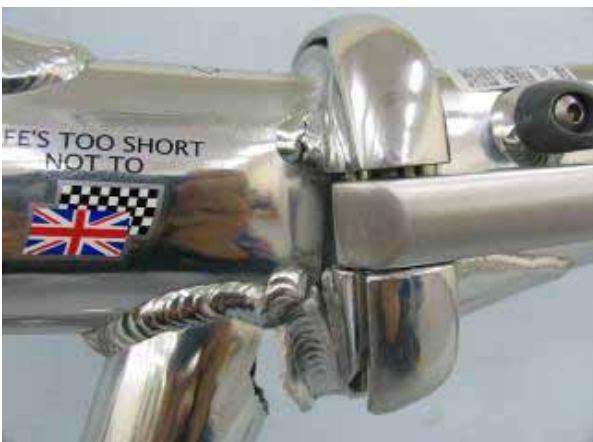
No.28耐振性試験による補強パイプ破損
