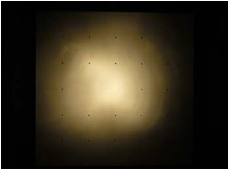
写真9 電球式 円形配光特性(No.33-6.58V)
