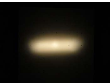
写真11 電球式 横長形配光特性(No.35-7.1V)
