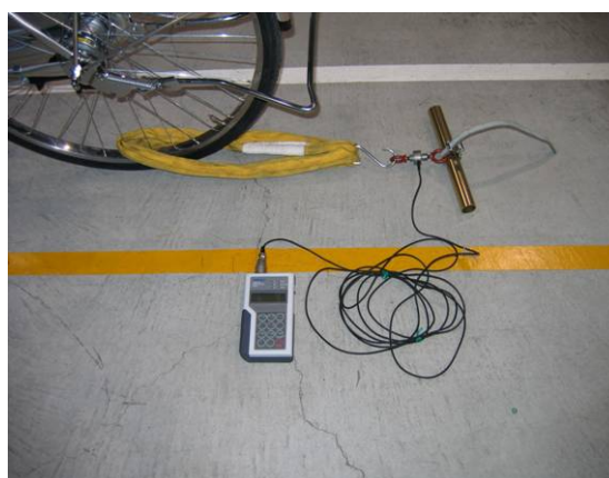
写真1 タイヤと路面との静摩擦係数の測定状況
