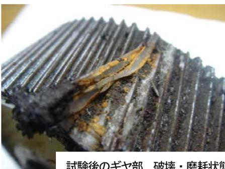
試験後のギヤ部 破壊・磨耗状態
