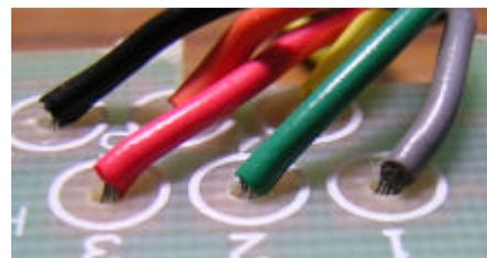
第9-a図．コード部実装後の皮膜状態
