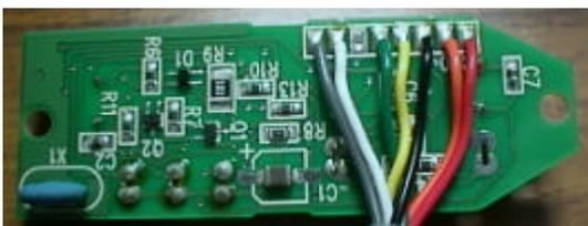
第11図 . 高機能型手元スイッチ基板
